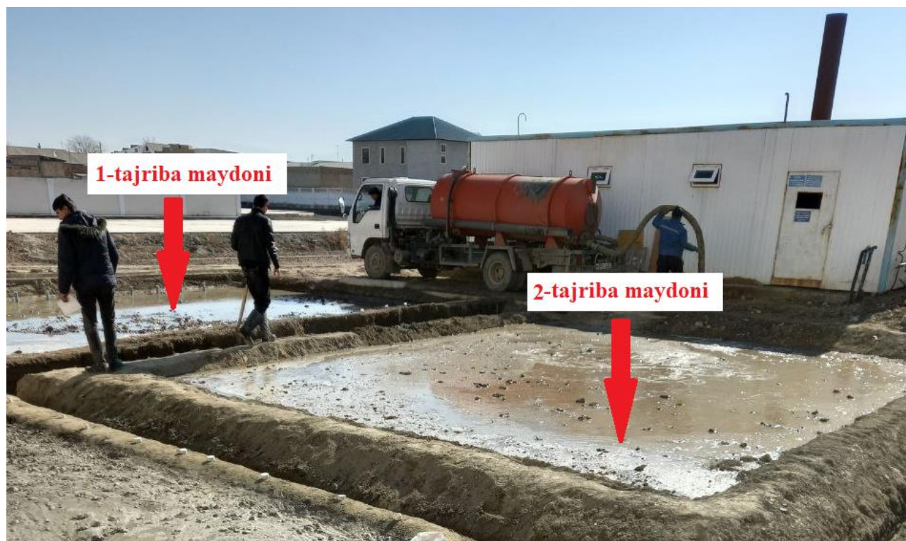
4-rasm. Tuproq tarkibidagi sho'rni yuvish jarayoni
